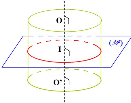
La section d'un cylindre par un plan  $(\mathcal{P})$  perpendiculaire à son axe est **un cercle**.
