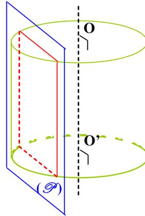
La section d'un cylindre par un plan  $(\mathcal{P})$  parallèlement à son axe est **un rectangle**.
