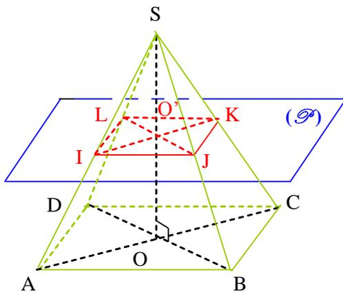
La section d'une pyramide par un plan parallèle à sa base est **une base réduite**.
